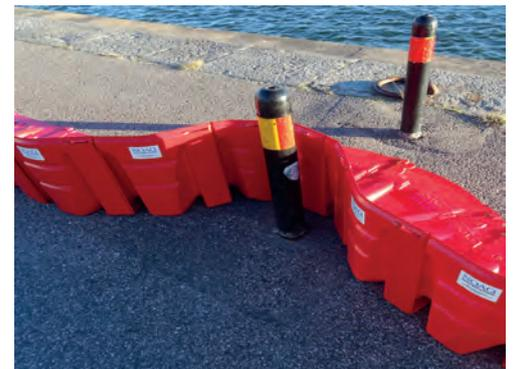
Der NOAQ Hochwasserschutz wird ganz einfach durch aneinanderfügen der einzelnen Elemente errichtet. Hierfür wird kein Werkzeug o.ä. benötigt. Kleinere Kurven können einfach durch Verbindung der Boxen in einem bestimmten Winkel kreiert werden. Ecken bzw. stärkere Kurven können mittels spezieller Kurvenelemente (Außen- und Innenkurven) erreicht werden.
